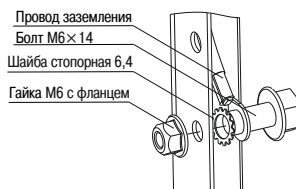
Рисунок 15 – Узел заземления на стойках
